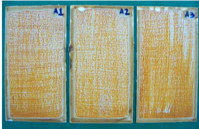
Imagen 3. Probetas de acero SAE 1010 después de 24 hs de exposición en cámara de prohesión
